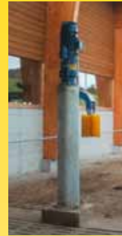
Antrieb mit Planetengetriebe auf Säule Entraînement par engrenage planétaire sur pilier
