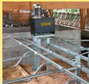
Hydraulikaggregat, stufenlose Geschwindigkeitsverstellung vorwärts/rückwärts Agrégat hydraulique, réglage de vitesse en continu en avant et en arrière
